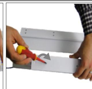
**Г.** Установить на монтажную базу (1) подвес с качельным крюком (6) 2 шт. (Допускается установка подвеса с качельным крюком (6) в начале линии светильников и в местах соединения светильников).
