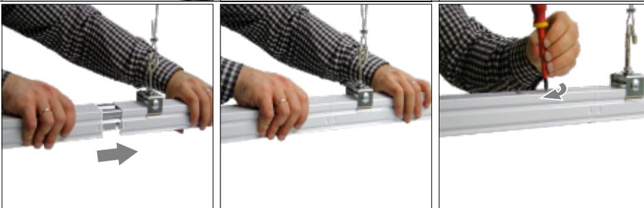
Ж. Соединить транзитные провода (поставляется в комплекте) между монтажными базами согласно маркировке.
