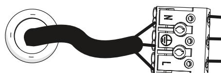
ПОДКЛЮЧИТЬ КАБЕЛЬ К КЛЕММНОЙ КОЛОДКЕ СОГЛАСНО ОБОЗНАЧЕНИЯМ НА КЛЕММНОЙ КОЛОДКЕ
